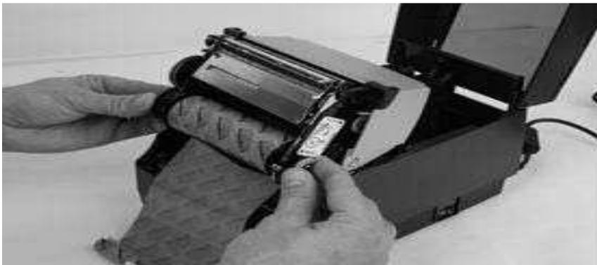
図 2-29. 供給ロール コアのノッチと、リボン スピンドルのノッチを合わせます。
