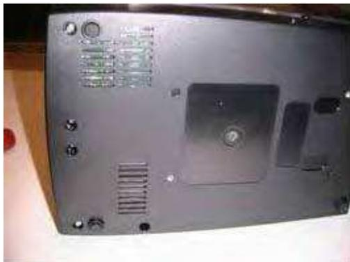
4. プリンタ裏面の2本のネジも外します。
