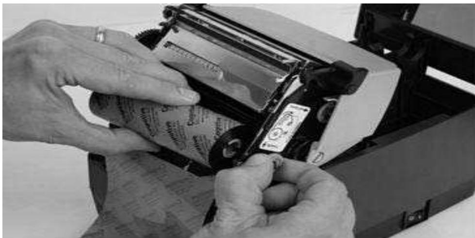
図 2-27. リボン供給コアのノッチと供給スピンドルのノッチを合わせます。
