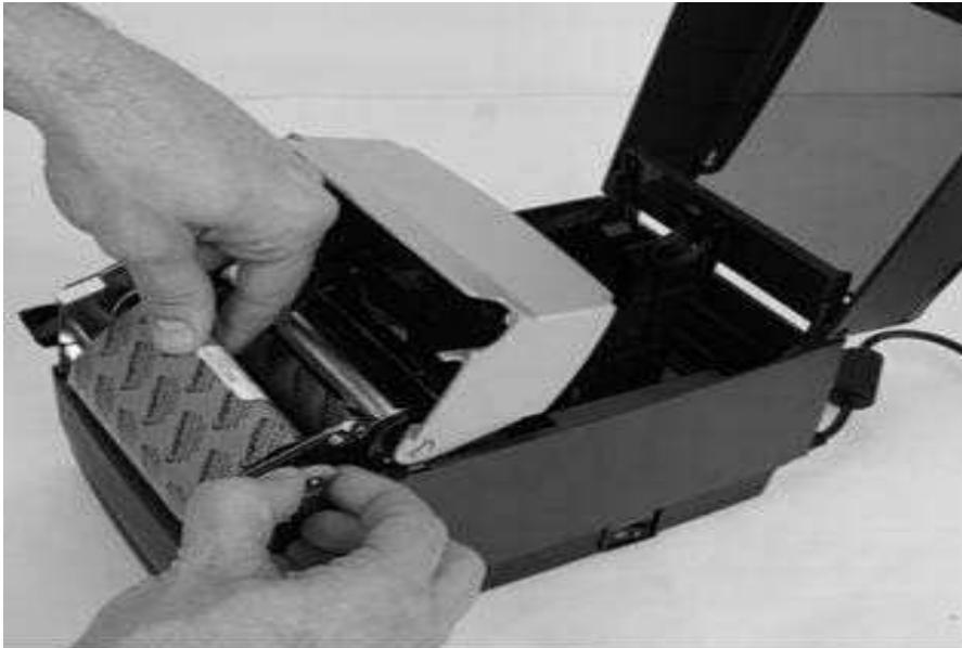
図 2-34. リボン巻き取りコアを巻き取りスピンドルノッチに固定する
