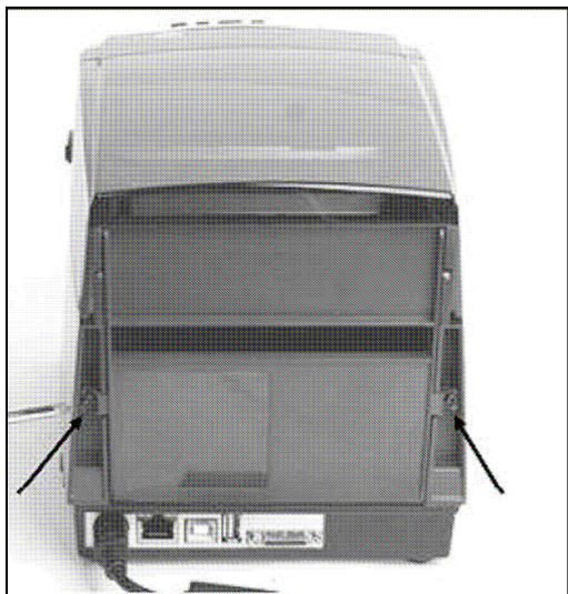
図 2-52. 矢印部分が背面カバーのネジ
