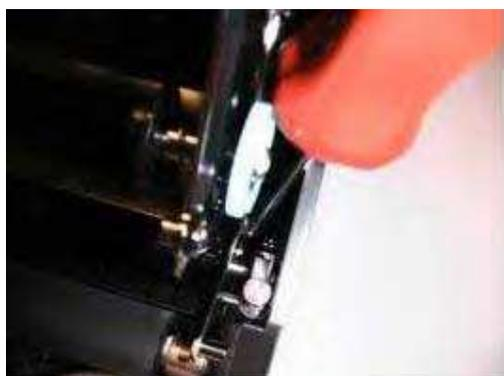
9. プリンタの裏面が見えるようにして、図に見えるように、3本のネジを取り付けて締めます。締め付けトルクは 3 インチ /ポンド (0.339Nm) で行います。
