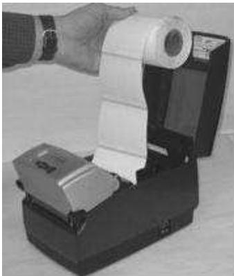
図 2-43b. 外巻きメディアを、印刷面を必ず上にしてセット
