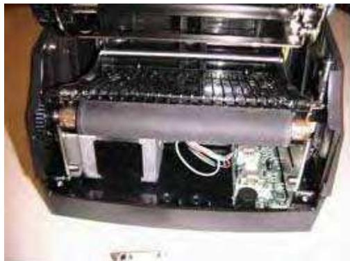
10. プラスチック製スナップの奥にある右側のプラテン ベアリングを、プリンタ前面に向けてスライドさせます。
