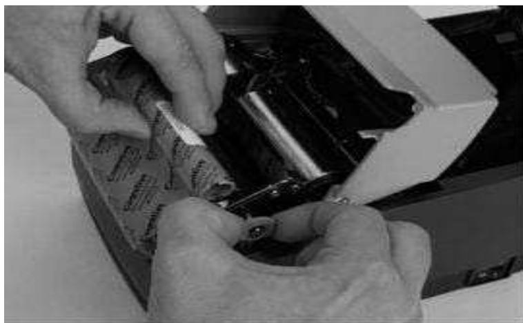
図 2-33. 巻き取りスピンドルを引き出して、巻き取りロールをはめ込みむ
