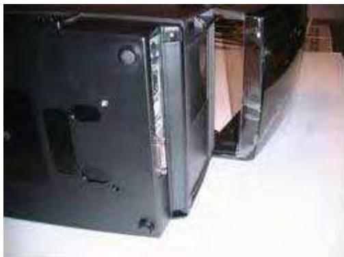
5. メディアガイドを底板に止めている4本のネジを外して、メディアガイドを取り外します。
