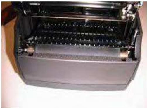
13. 図のように、ベゼルのネジ 2 本を取り付けて締めます。締め付けトルクは 3 インチ/ポンド (0.339Nm) で行います。
