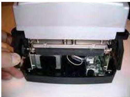
6. 筐体の ON/OFF スイッチ タブが、図のように ON/OFF の上にあることを確認します。これにより、筐体が底部上の正しい位置にあることが確認できます。底部に筐体がしっかり嵌っていることを確認します。この時、ユーザ インターフェイス カバーは自由に回転できなければなりません。カバーが自由に回転できない場合は、筐体の位置が正しくありません。
