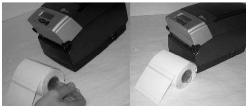
図 2-39b. Cognitive 承認の外巻きメディアにスピンドルを差し込む
