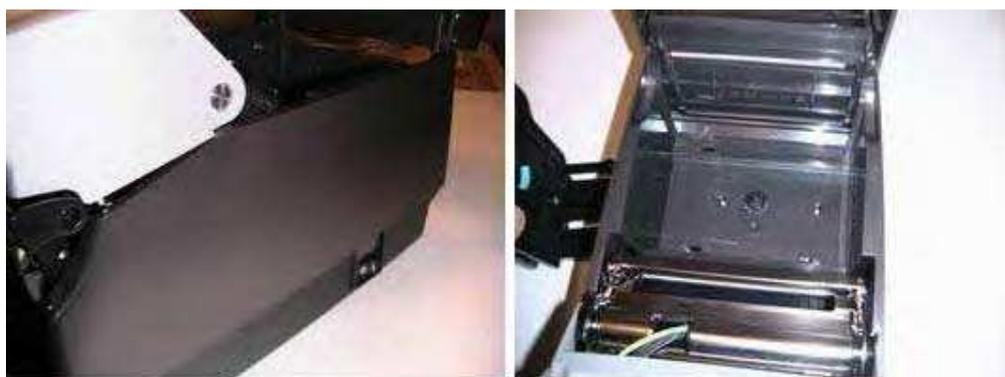
8. 機構の右側、下向きのスイッチの奥の 2 本のネジを取り付けて締めます。締め付けトルクは 3 インチ/ポンド (0.339Nm) で行います。
