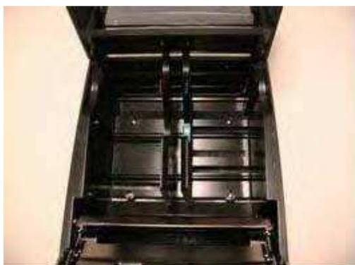
6. メディア ガイド ギアを外して、プリンタの側に置いておきます。その後で、ガイドが外れたことで見えるようになった 2 本のネジを外します。
