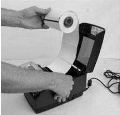
図 2-43a. 内巻きメディアを、印刷面を必ず上にしてセット
