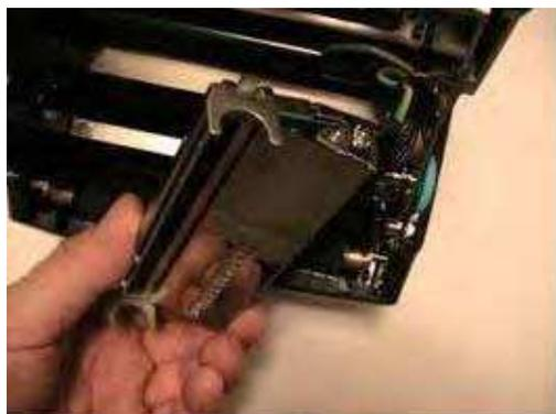
4. プリントヘッド ケーブル ハーネスをプリントヘッドから取り外し、LED コネクタから、2 線 LED ハーネスも取り外します。
