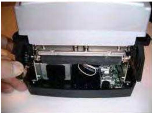
9. 前面ベゼルを取り外します。筐体の取り外し可能部分の、前面ベゼルが取り外せる部分をよく確認します。
