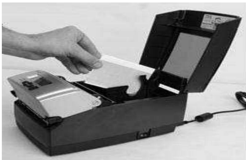
図 2-38. プリンタから製造時のテスト サンプルを取り出す
