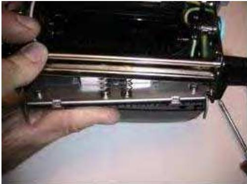
7. プrintヘッドを押し上げてから後ろに押し、左のPrintヘッド ブラケット サポート タブが左側のプラットフォームに乗るように置きます。
