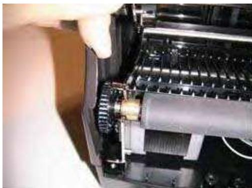
3. 右側のプラテン ベアリングを、プラスチック製スナップの中にスライドさせます。プラテンが、プラテン ベアリングの中できちんと回転することを確認してください。ギアとモーターがあるため、若干の抵抗は生じます。
