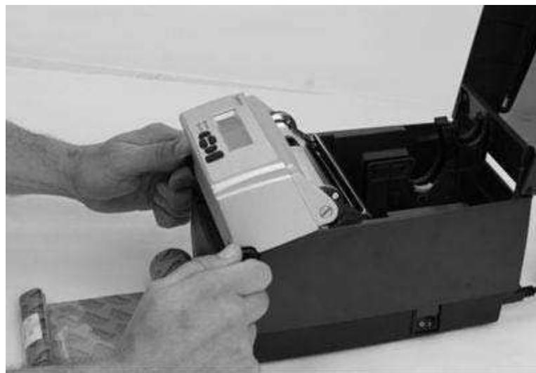
図 2-24. プリントヘッド機構のラッチを外す
