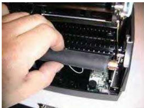
11. 筐体を、プラテンの左側から離す方向に、少しだけ傾けます。プラテンの左側をプラスチックのキャップから外し、プリンタの前面へ向けてスライドさせます。
